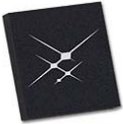
Multichip Module (MCM) 6 x 6 mm
