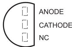
LM285-1.2, LM385-1.2, LM385B-1.2 . . . LP PACKAGE (TOP VIEW)
