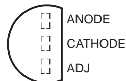
LM336-2.5, LM336B-2.5 . . . LP PACKAGE (TOP VIEW)
