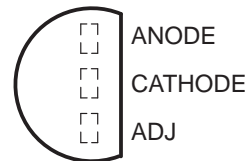
LM336-2.5, LM336B-2.5 . . . LP PACKAGE (TOP VIEW)
