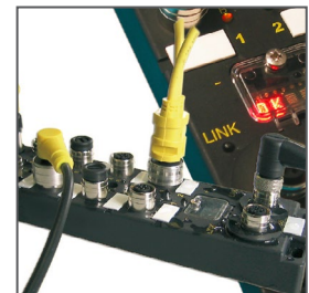
Smart I/O modules
